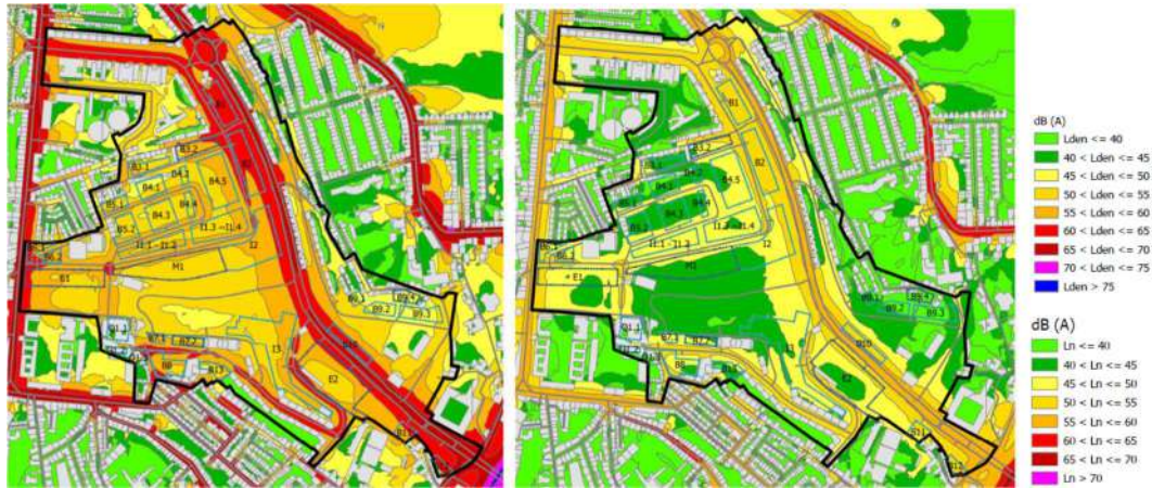
Figura 10 – Mapa de Ruído Global – Situação Futura 2029 – Lden e Ln - Aplicação de pavimento poroso com características absorventes sonoras + redução da velocidade máxima para 30 km/h em toda a área do Plano.
