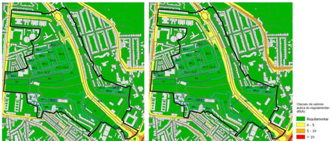
Figura 9 – Mapa de Conflitos - Ruído Global – Situação Futura 2029 – Sem Medidas – Lden e Ln.
