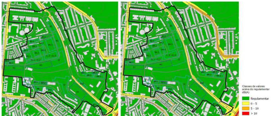
Figura 11 – Mapa de Conflitos - Ruído Global – Situação Futura 2029 – Lden e Ln - Aplicação de pavimento poroso com características absorventes sonoras + redução da velocidade máxima para 30 km/h em toda a área do Plano
