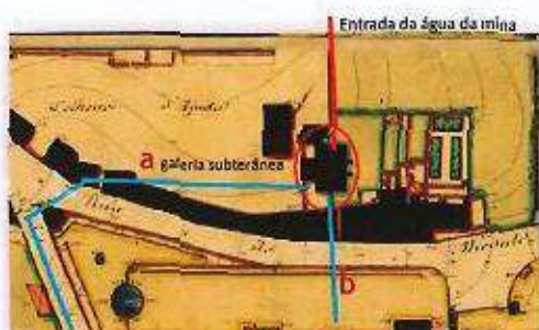
Planta 1 – Pormenor da planta de 1911 de Silva Pinto com representação da cisterna assinalada pela oval vermelha e traçado da galeria M11 pela linha azul.
