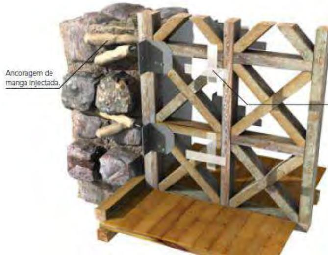
PMa2 - Pormenor das ligações aparafusadas do frontal às paredes de alvenaria de pedra
